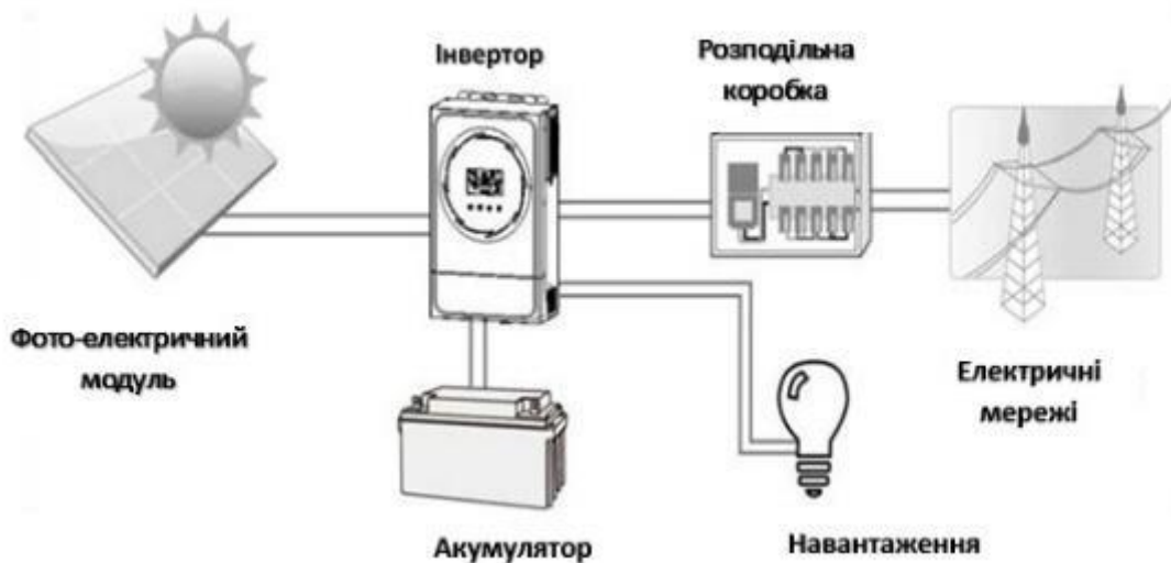
Малюнок 1 Загальний огляд фотоелектричної системи
